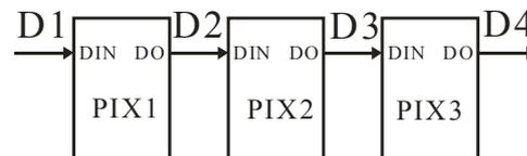
**数据传输时间** ( $T_H + T_L = 1.25\mu\text{s} \pm 150\text{ns}$ )
